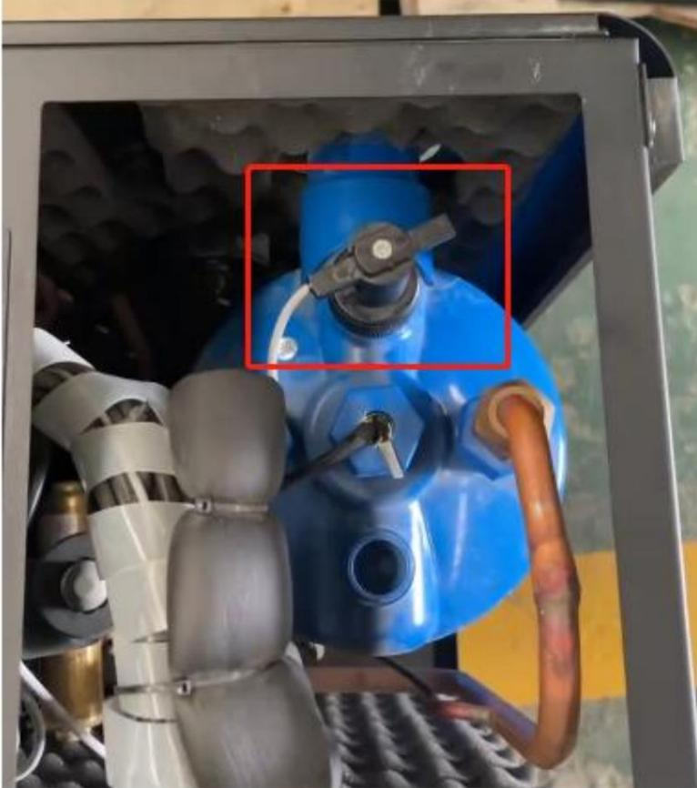
2. Halten Sie den schwarzen Schraubverschluss mit der Hand fest und drehen Sie ihn gegen den Uhrzeigersinn, um den Wasserdurchflussschalter zu entfernen
