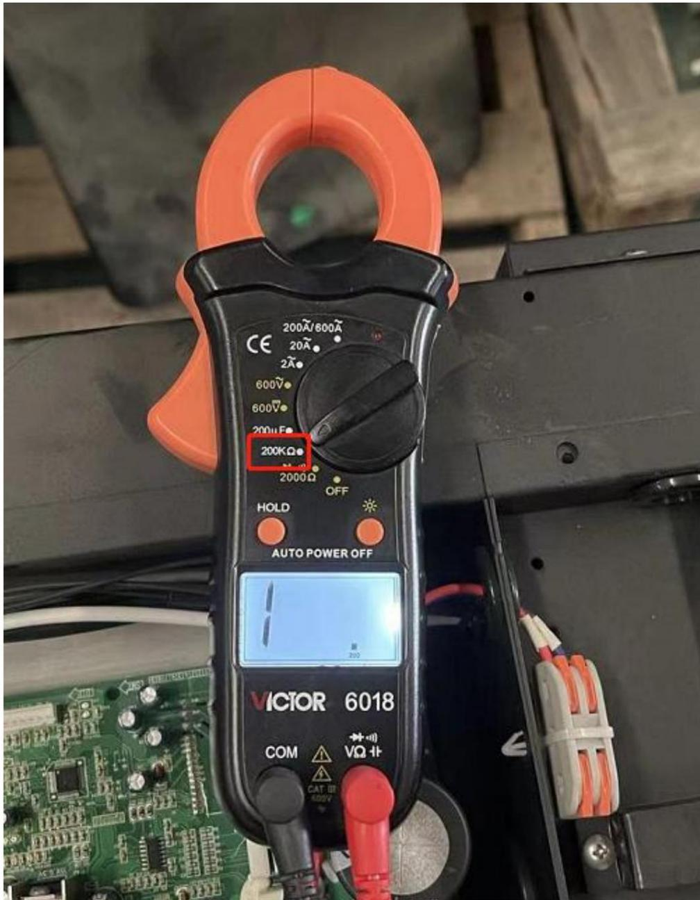
5. Verwenden Sie beide Enden des Multimeters, um die Anschlüsse des Wasserdurchflussschalters anzuschließen.
