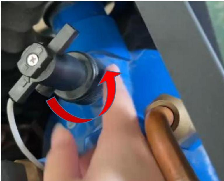
3. Ein Wasserdurchflussschalter besteht aus einem Hauptgehäuse und einem Kabel mit einer Klemme, die in den TS1-Anschluss auf der Platine gesteckt werden sollte.
